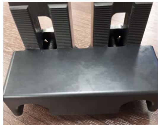
38. ábra: Középre igazított sablonrácstartó
